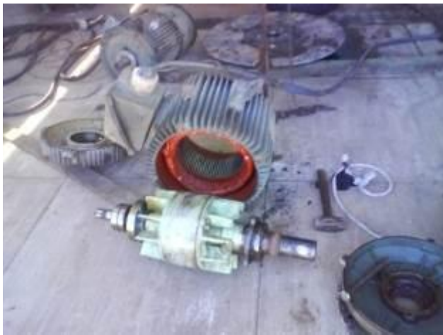
Fotografía 4.- Traslado de motor eléctrico para efectuar mantenimiento correctivo.
